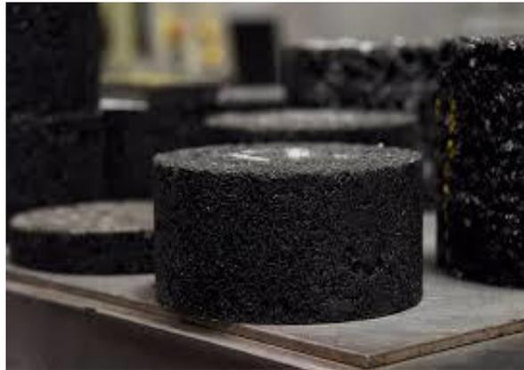
Probetas moldeadas en laboratorio de obra a 120°C.
